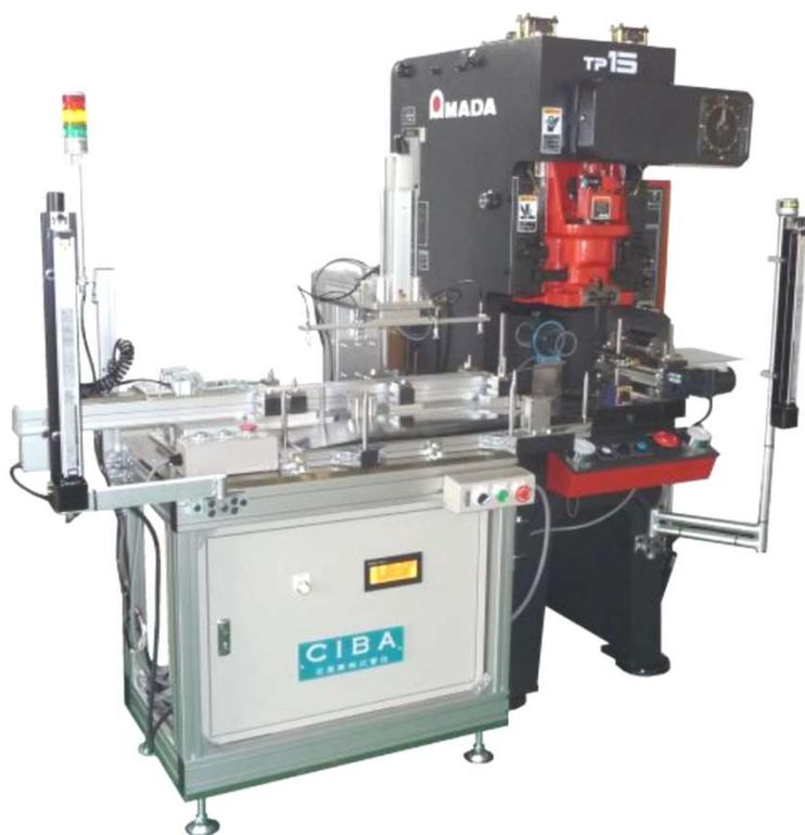
XY2軸NC制御で千鳥配列にも対応しており歩留まり良く加工する事が出来ます。
